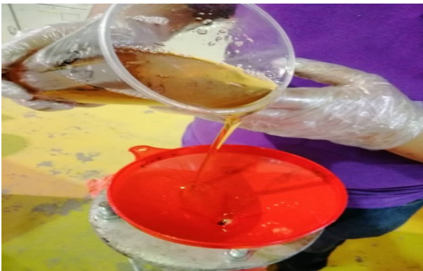
(d) Fill up the polyol first then isocyanate.
