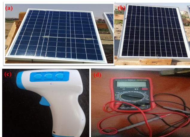
Fig. 2: The photovoltaic (a) polycrystalline, (b) monocrystalline modules, (d) digital thermometer (c), and multimeter (d) used for testing.
